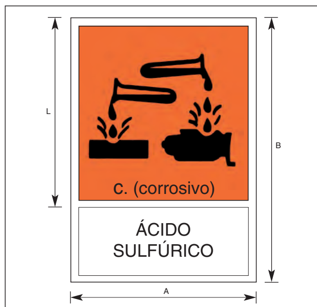
Figura 6. Señal tipo panel para recipientes y tuberías.
